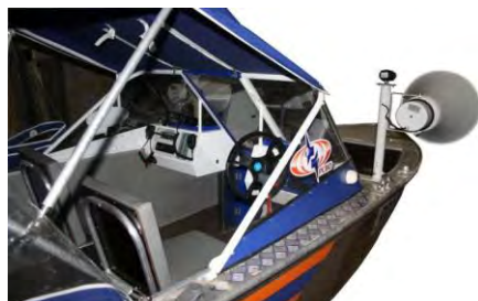
Рисунок 6.2.3 – Размещение аппаратуры оповещения комплекса ВМКО
