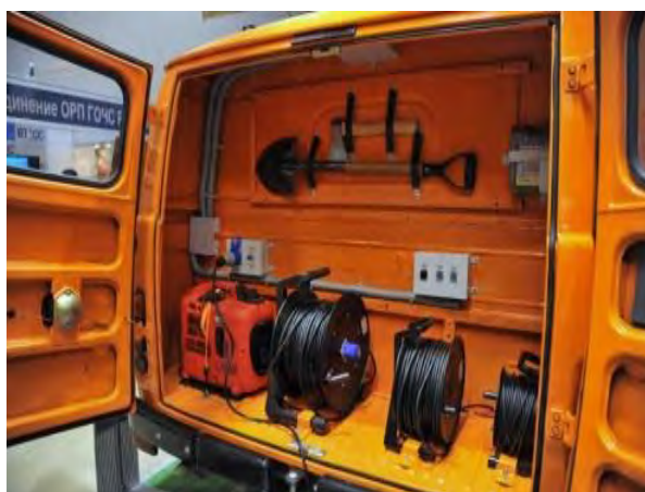
Рисунок 6.1.3 – Кабельный отсек
