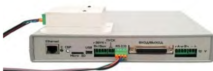
Рисунок 1.2.2– Блок управления универсальный П-166Ц БУУ-02 с акустическим анализатором.
